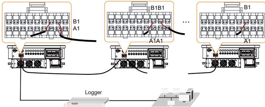
COM2 Connection (DRM) / Conexión COM2 (MRD) / COM2 (DRM) توصيل / Anschluss COM2 (DRM) / Połączenie COM2 (DRM) / Branchement COM2 (DRM) / Conexión de COM2 (DRM) / Collegamento COM2 (DRM) / Conexiune COM2 (DRM) / Conexão COM2 (DRM) / COM2-aansluiting (DRM) / COM2-liitäntä (DRM) / COM2-anslutning (DRM) / COM2 csatlakoztatás (DRM) / Ligação COM2 (DRM) / Подключение COM2 (DRM)
