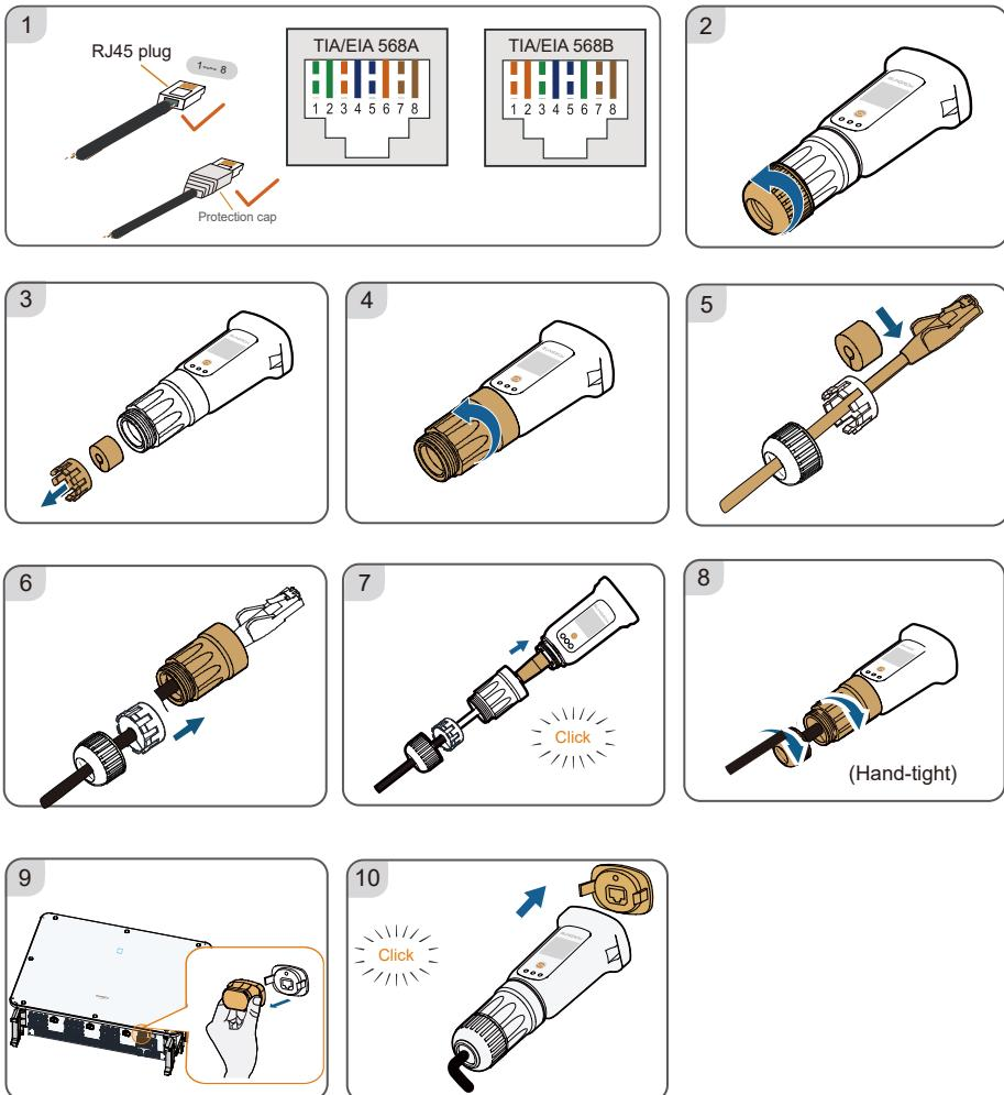
RS485 Communication Connection / Caja de conexiones de comunicación RS485 / RS485 انصراف اتصالات / Anschluss RS485
