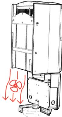
Figure 12: Inverter fan - airflow
